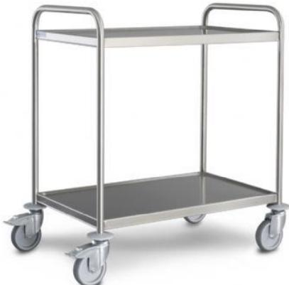
Chariots de service en inox 18/10 se composent de deux tubes rond cintrés diam. 25 mm, formant poignée. Des plateaux emboutis à bords profilés sont soudés entre ces tubes. Une mousse de polyuréthane est collée sous les plateaux de façon à l'insonoriser pendant la manipulation. Nos chariots sont équipés de façon standard de 4 roues pivotantes diam.125mm dont 2 à freins en acier chromé zingué ou polyamide et pare-chocs ronds.
